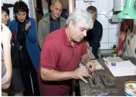
Мальчевський К. В. (Виготовлення повітряного гвинта шляхом формування)
